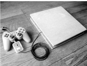
お尻の圧力が電気信号に変換され、コントローラーなどを操作する。
